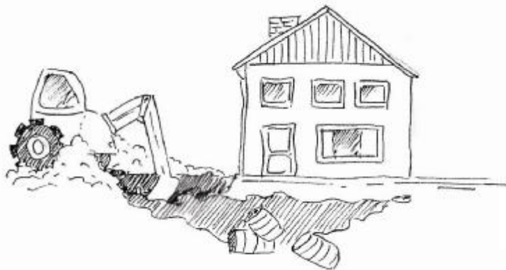
Figuur 1 Bodemsanering onder een woning
