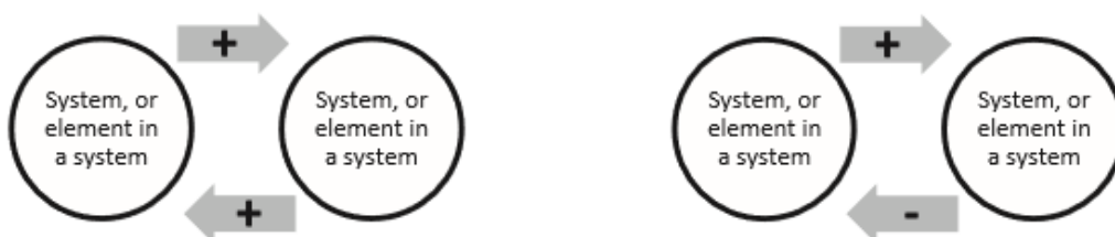
Figuur 1: Positieve feedback loop (links); negatieve feedback loop (rechts) (Gerrits, 2012)
