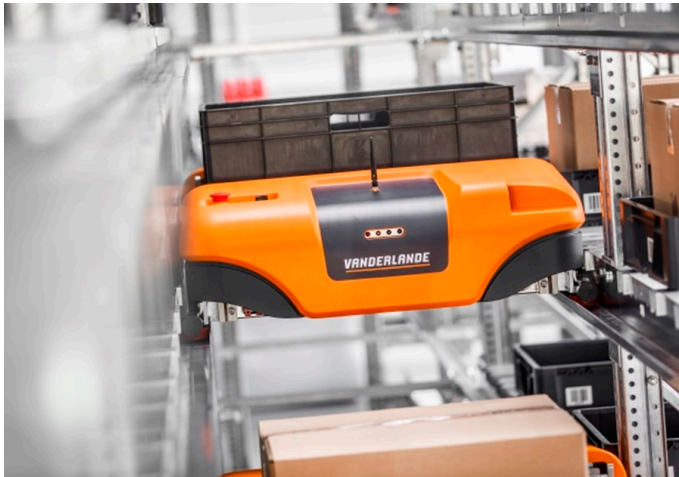
Figuur 2 - Een AVS/R-systeem van Vanderlande
