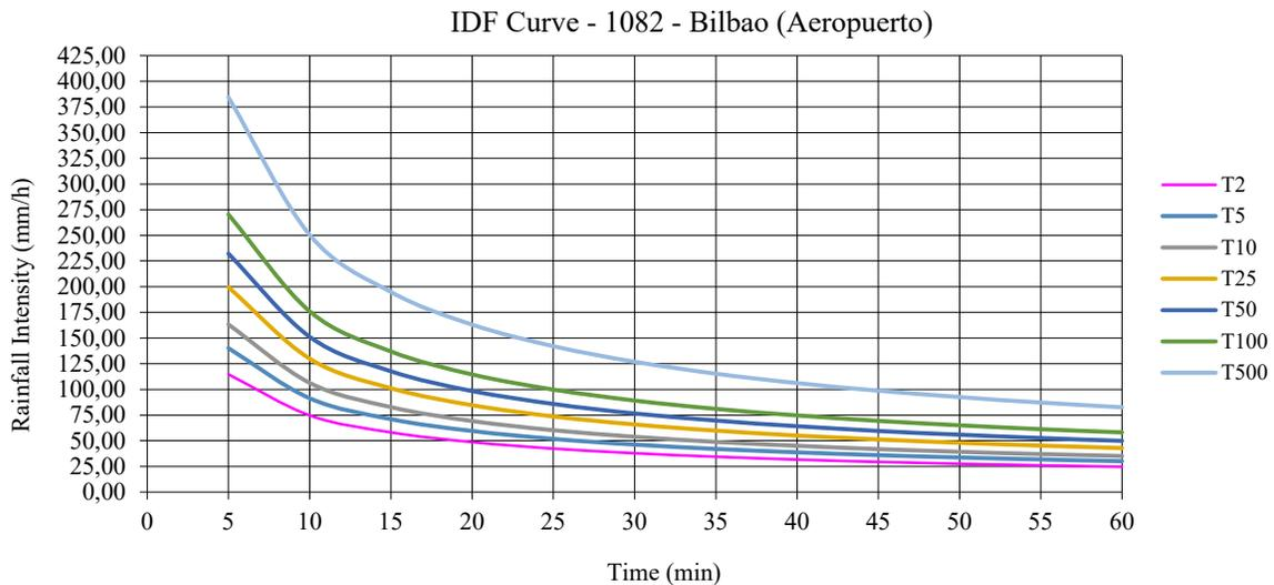
**Figure 10 Intensity-Duration-Frequency Curve 1082 – Bilbao (Aeropuerto)**
