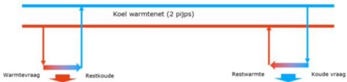
Figuur 5: Transport van warmte en koude in 2-pijpsnetwerk(Muller et al., 2020 p.130)
